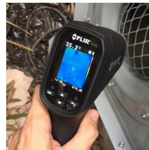
Medición de temperatura a la salida del sistema. El resultado de la medición es de 25,6 C lo cual significa una diferencia de 9,6 C con respecto a la temperatura de entrada.
