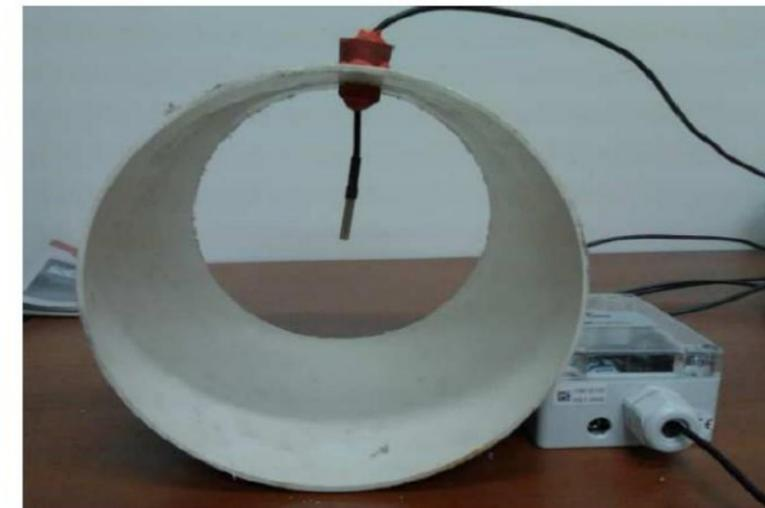
Un termómetro fue instalado dentro del sistema para monitorear la temperatura de aire durante su operación a lo largo de un periodo de tiempo. Otros dos termómetros fueron utilizados para medir la temperatura del suelo y la temperatura de ambiente respectivamente.
